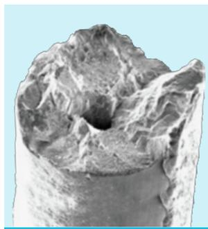
Analyse de rupture d'un brin conducteur.
