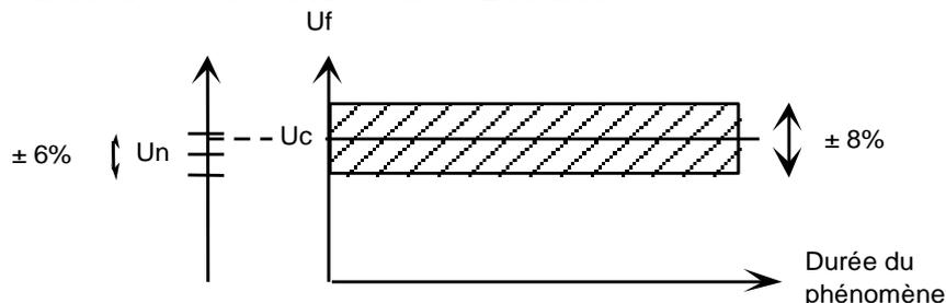
Pour le 150 kV, la Tension d'Alimentation Déclarée ( $U_c$ ) est située dans une plage de  $\pm 7\%$  autour de la Tension Nominale ( $U_n$ ). L'amplitude de la Tension de Fourniture ( $U_f$ ) peut varier de  $\pm 10\%$  autour de la Tension d'Alimentation Déclarée, sans toutefois dépasser 170 kV (tension maximale liée au dimensionnement des matériels).
