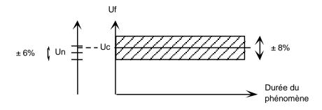
Pour le 150 kV, la Tension d'Alimentation Déclarée (Uc) est située dans une plage de ± 7 % autour de la Tension Nominale (Un). L'amplitude de la Tension de Fourniture (Uf) peut varier de ± 10 % autour de la Tension d'Alimentation Déclarée, sans toutefois dépasser 170 kV (tension maximale liée au dimensionnement des matériels).
