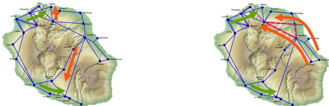
Figure 10 Synthèse des flux et des contraintes à la Réunion à la pointe du soir et à la pointe méridienne (source EDF SEI)
