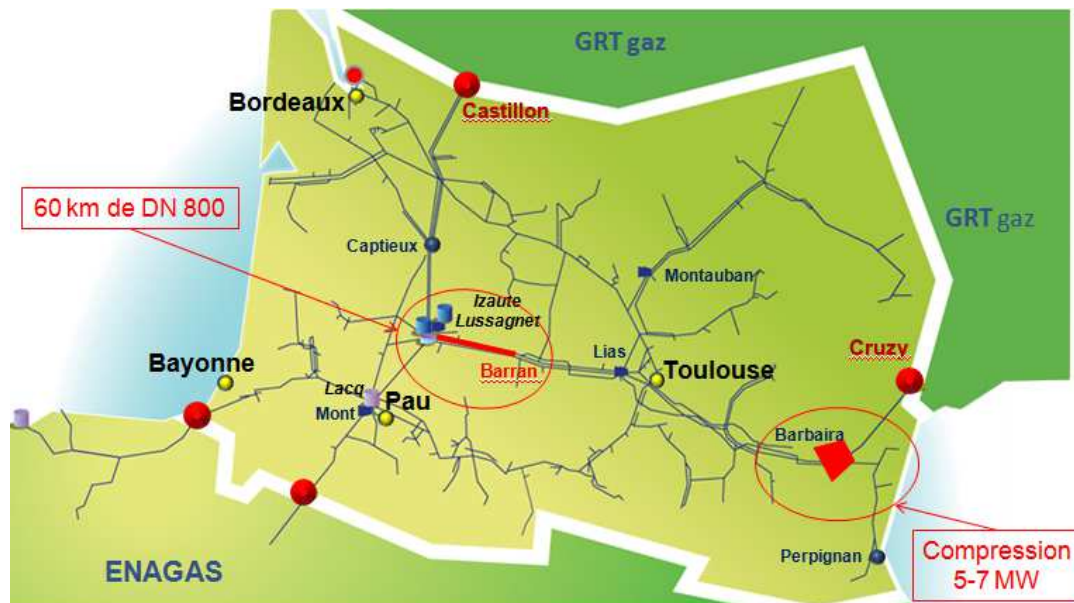
Figure 7 - Ouvrages proposés sur le réseau TIGF
