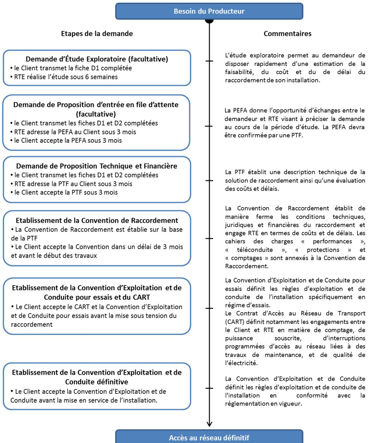
Le raccordement de l'installation est réalisé dans les conditions mentionnées dans la Documentation Technique de Référence en vigueur au moment de l'envoi de la PTF. Il donne lieu :
