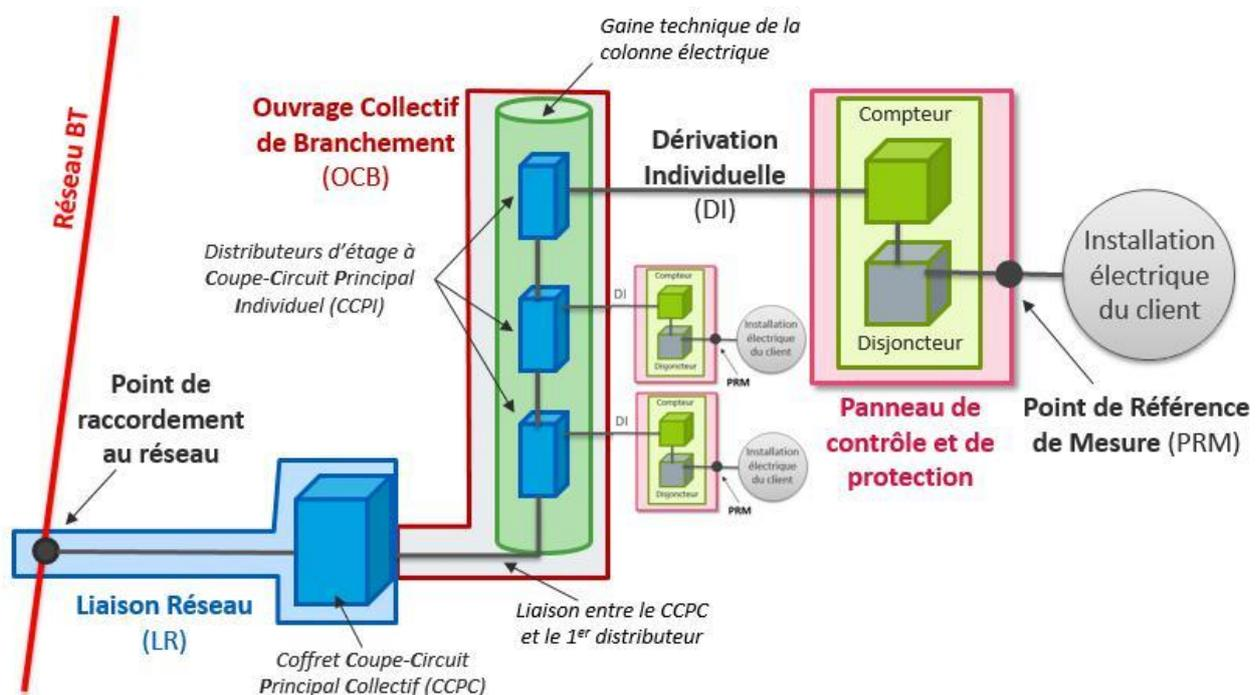
Remarque : l'OCB peut se limiter à un local technique regroupant l'ensemble des distributeurs d'étage et doit répondre à la NF C 14-100 en vigueur excepté pour la hauteur sous plafond qui ne peut être inférieure à 2,2 m.
