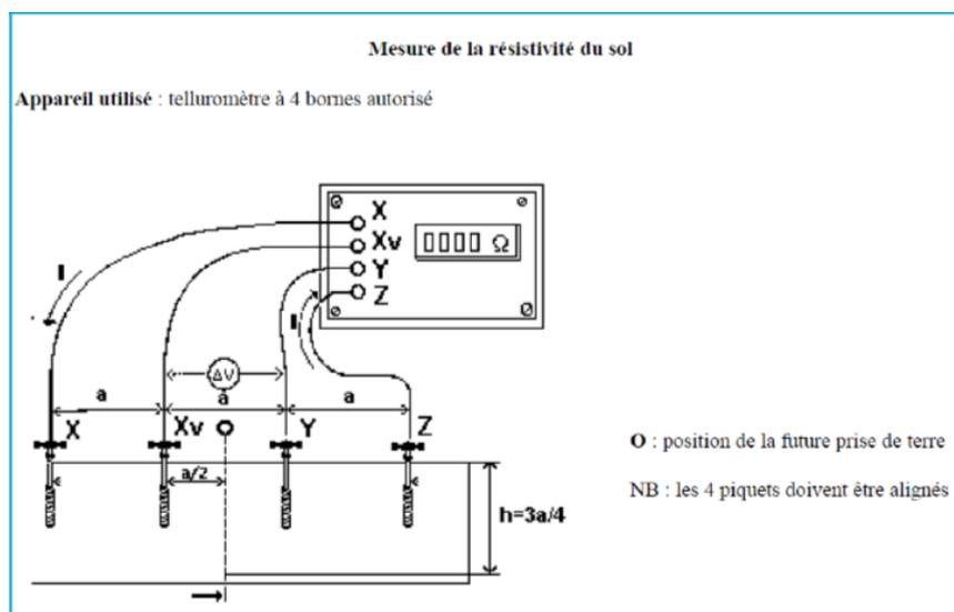
En pratique, l'Entreprise Agréée réalise 2 mesures (en s'écartant au maximum des ouvrages en place), avec une distance dite « base de mesure » de 4 puis de 8 mètres entre 2 électrodes adjacentes, dans 2 directions perpendiculaires.
