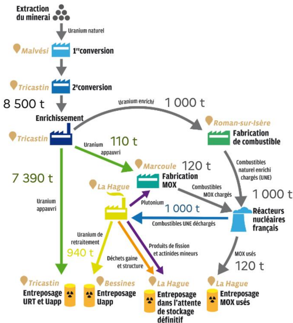
Figure 20 – Principaux éléments du cycle du combustible en France et installations associées.
