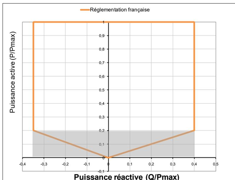
Pour tous les points de fonctionnements compris entre 20% et 100% de  $P_{max}$  dans le gabarit décrit ci-dessus, l'installation devra être en mesure de mettre en œuvre les modes de régulations suivants :
